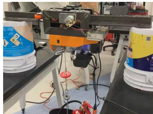
Fig. 2. Grúa de techo en funcionamiento.
